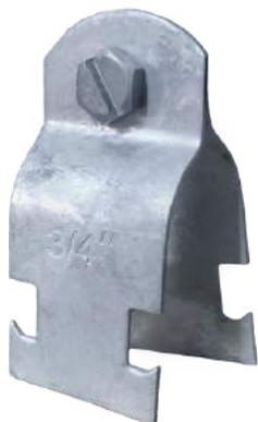
Abrazadera para soporte de tubos tipo RIGID, IMC Se monta directamente en canales/rieles strut Ensamblaje mediante tornillo y contratuerca. Cuerpo de acero galvanizado en caliente (mínimo 1.5 oz de zinc por un pie cúbico de acero). Espesor de 12 gauge (2.7 mm).
