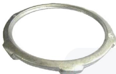
Las contratuerca de seguridad fundidas a presión de acero Galvanizado. se utilizan para asegurar conductos roscados o conectores a cajas de conexiones eléctricas o recintos en lugares húmedos.
