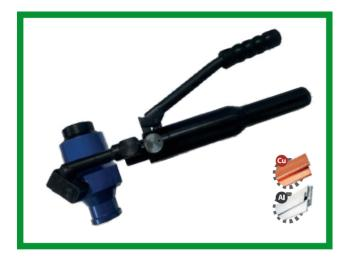
WK-8AL: KIT Sacabocado Hidraulico con cabeza giratoria 360
